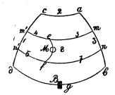
волоки ав и какія нибудь ен части т и п соединяють съ концами проволоки са и нѣкоторыми частями ен т' и п'. Проволока са произвольной длины, сопротивленія вообще незначительнаго; также произвольно сопротивленіе проводника dgb, заключающаго въ себѣ гальваническую баттарею; проволоки же
