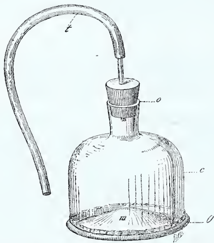
FIG. 3. — Appareil de diffusion. — m , membrane à travers laquelle s'opère la diffusion ; O , grande ouverture de la cloche c , fermée par cette membrane ; o , petite ouverture de la cloche, par où se fait le vide au moyen du tube t .
