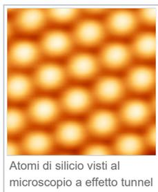
Atomi di silicio visti al microscopio a effetto tunnel
