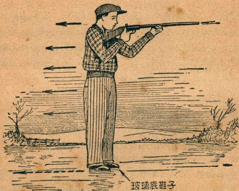
圖 119. 假使一個人穿着玻璃底的鞋子，立在冰上，依同一方向連續放着重鎗，他會沿一直線的路徑向後移動。
