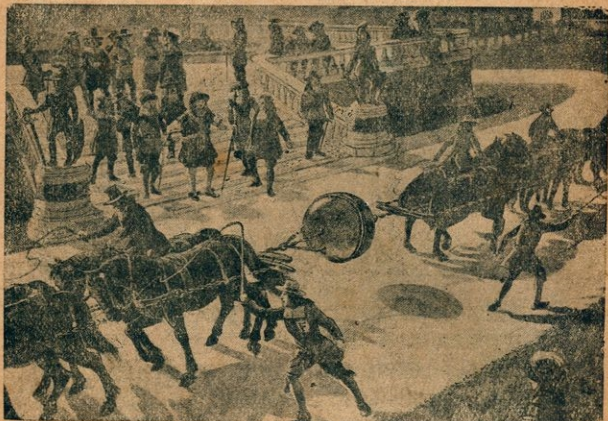
圖 196. 德國科學家葛列克在十七世紀時於馬德堡地方實驗大氣壓力的情形。二個半球密切對合，球內抽出了空氣，要用二十匹馬才能把它們拉開。
