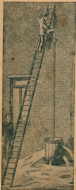
圖 176. 一瓶水能裂開一只堅固的木桶。
