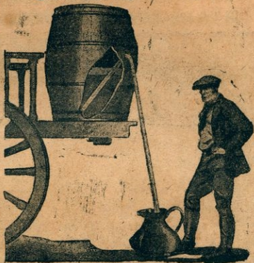
圖 208. 用虹吸管把上面一桶酒吸盡。大氣壓力把液體由管的短臂中推起達到彎頂，而後液體自身的重量，使它由長臂中流出，注於下面的壺內。
