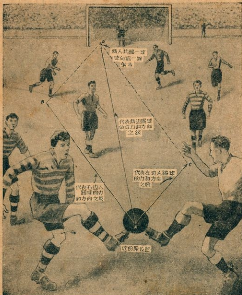
圖 102. 此圖說明兩力同時作用於一物上所發生的現象。一個足球同時被兩球員所踢着，右邊那人踢球用力的大小與方向用AB線來代表，左邊那人踢球用力大小與方向用AC線來代表。可是這球並不向那二者中任一方向前進，而向AD方向前進。這球所受的力，與它所有的速度，都可用AB與AC兩條線來代表。在AB及AC上作一平行四邊形，由A起的對角線，就代表合速度與合力的大小及方向。這樣求合力及合速度的方法，在力學中就叫力的平行四邊形法及速度的平行四邊形法。
