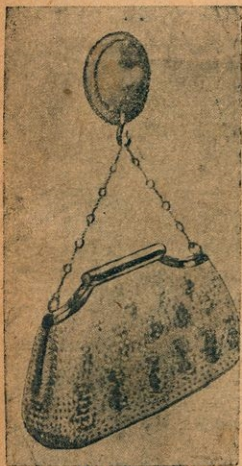
圖 197. 用一塊圓盤狀橡皮，上附一掛物的鈎。把橡皮盤用水潤溼以後，壓在玻璃窗上，因為玻璃和橡皮之間，沒有空氣，外邊的大氣壓力，把它壓住。橡皮不但不墜下，而且可以掛起一個提包。
