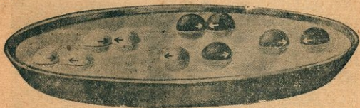
圖 140. 本圖表示濕的表面與不為水所溼的表面的行為（為水所溼）。小球係用軟木製，黑色球的面上塗有油脂（不為水所溼），其他的球絕無油脂。箭頭表明這些球如何互相吸引，互相推斥。
