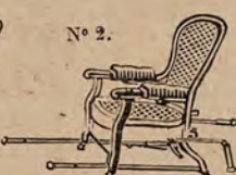
FAUTEUIL canné, dossier articulé. Roues métal caoutchoutées. Porte-jambes mobile à 2 articulations. Se transforme en portoir avec brancards à tourreaux comme fig. N° 2.
