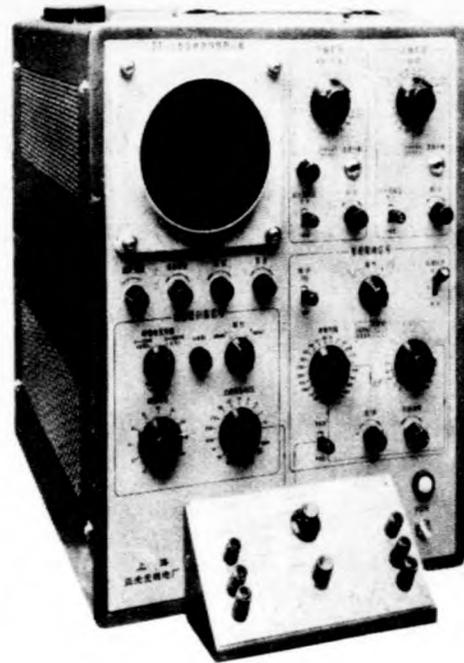
JT—1型晶体管特性图示器
