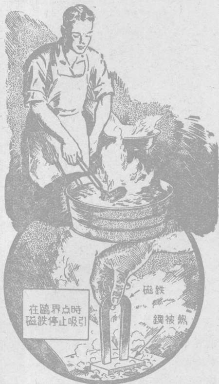
圖103. (上)把鑄鐵加熱到鮮紅色，而後浸入水中，可增加鑄鐵的硬度與耐用性。(下)鋼被熱到臨界點時，磁鐵不能吸引它。
