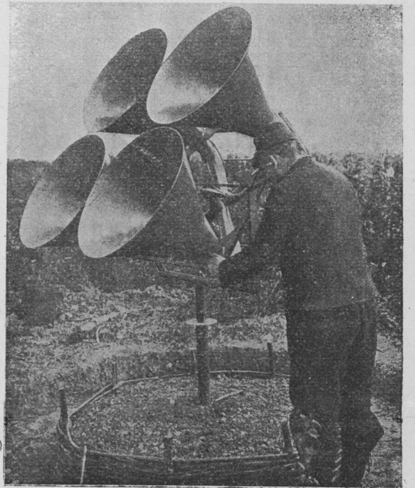
Подслушиватель - аппаратъ, заблаговременно извѣщающій о приближеніи непріятельскихъ аэроплановъ и цеппелиновъ.
