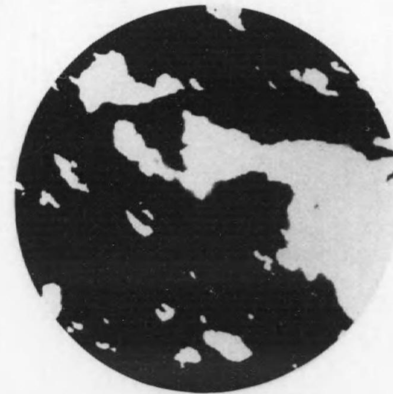
東澳嶺鑛床第3坑鑛石 磁硫鐵鑛 (60倍平行=コル) Pc. 磁硫鐵鑛 C. 方解石 Q. 石英
