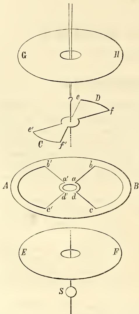
La fig. 1 mostra schematicamente le parti principali del nuovo elettrometro, disegnate però, per chiarezza, a distanze reciproche assai esagerate.
