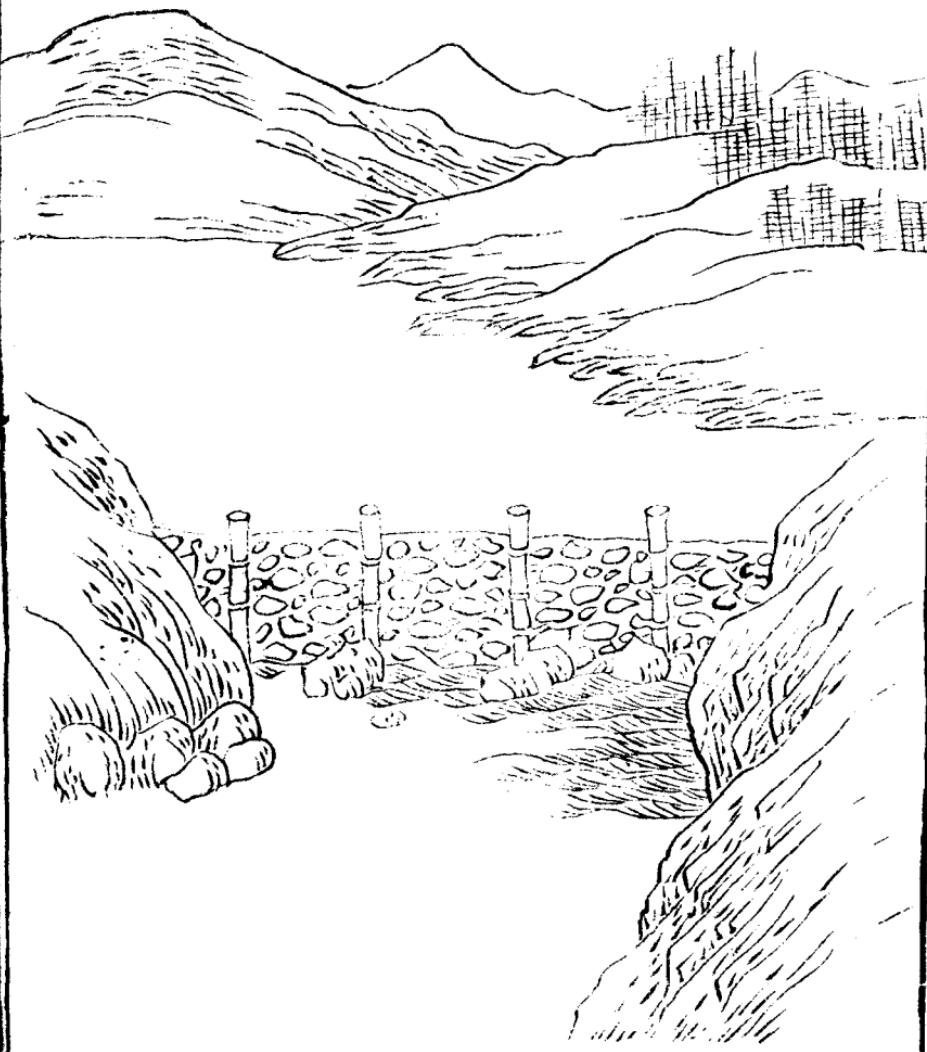
石籠力<sub>董</sub><sub>切</sub>又謂之臥牛判竹或用藤蘿或木條編作圈眼大籠長可三丈高約四五尺以鐵樁止之就置田頭內貯塊石用擘暴水或相接連延遠至百步若水勢稍高則壘作重籠亦可遏止如遇隈岸盤曲尤宜周折以禦奔浪併作洄流不致衝蕩埂岸農家瀕溪護田多習此法比於起疊堤障甚省工力又有石筍攔水與此相類詩云誰編藤竹作長籠<sub>廬</sub><sub>紅</sub>塊石填來勢自雄<sub>螳</sub><sub>切</sub><sub>計</sub>蠅<sub>切</sub>孔有形橫巨浸鯢鱣無力戰秋風波濤已捲奔騰勢壠畝都歸扞禦功擬喚六丁鞭爾去若爲能障百川東
