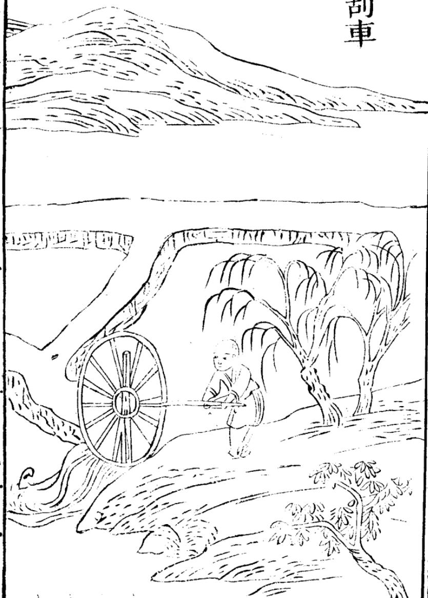
輻同潤然後立架安輪輪半在槽內其輪軸一端環以鐵鈎木拐一夫執而掉之車輪隨轉則衆輻循槽刮水上岸溉田便子車厚詩云創物須憑智巧先泝流能使
