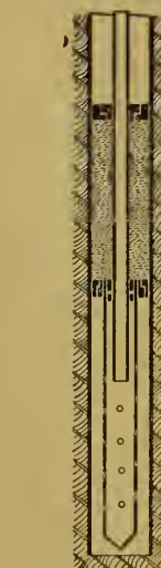
Abb. 11. Einpressung von Zement unter Verwendung einer Moosbüchse.
