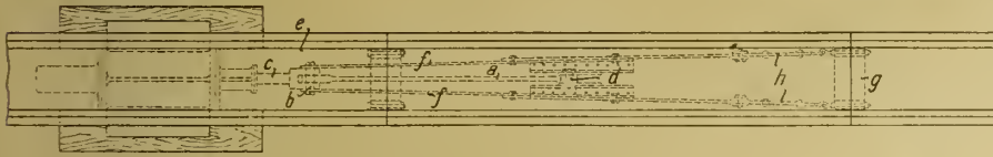
Abb. 2. Grundriß des Schüttelrutschenantriebes mit Spannvorrichtung.
