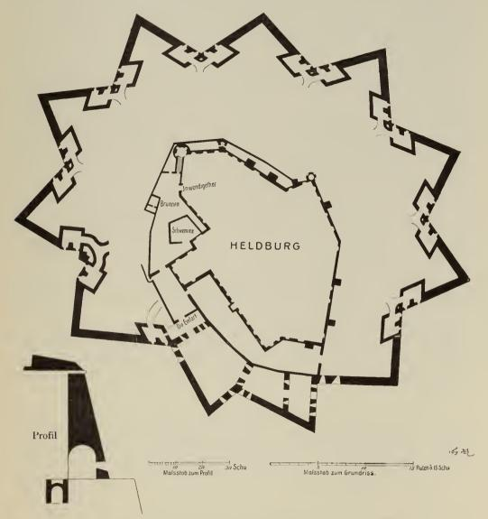
Abbild. 26. Nicht ausgeführter Plan zu einer Befestigung der Veste Heldburg, Mitte des 17. Jahrhunderts.
