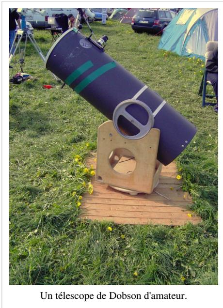
Un télescope de Dobson d'amateur.
