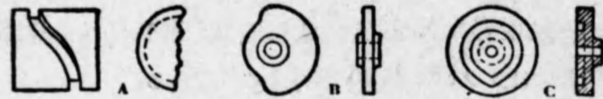
第52圖 カムの種類 A: 圓筒カム B: 板カム C: 正面カム
