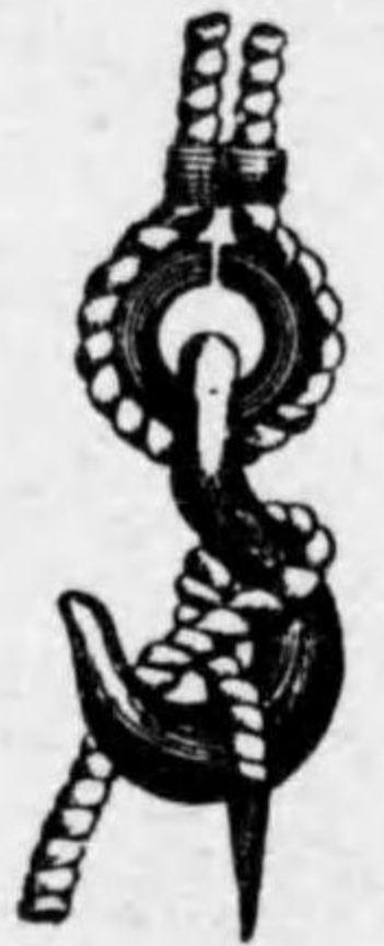
鉤結 〔カケムスビ〕 (シングル・ブラック・ウオール・ヒツチ) (ダブル・ブラック・
