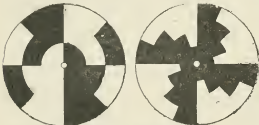
Fig. 2. - Discos rotatorios; experimentos sobre la persistencia de las impresiones luminosas
