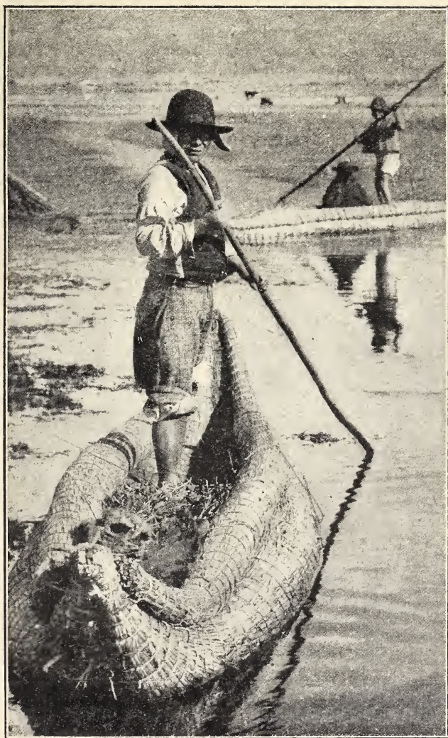
Balsa de enea en el Titicaca, para la navegación en sus canales, movida por varas o «tancanas».
