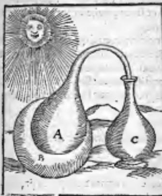
Autre Cornue avec le recipient assise en vn mortier de marbre ou de fer, pour pareillement distiller au Soleil.
