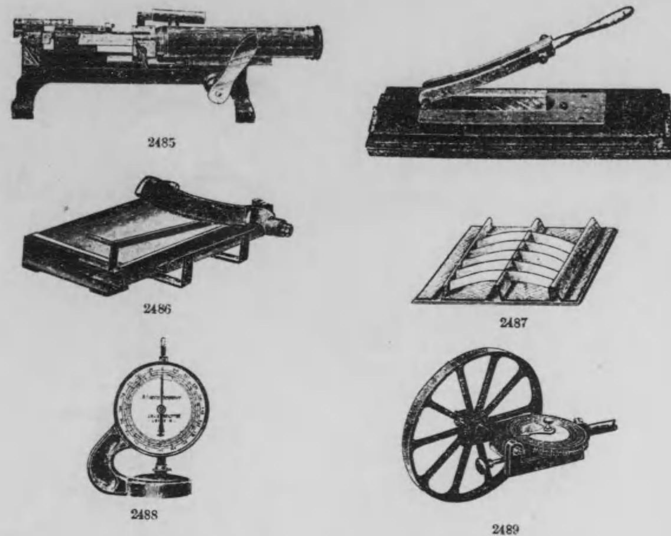
*2485 紙強迅速試験器 Rapid Paper Tester, for the determination of tensile strength, with a paper cutter. 本器ハ紙ノ強度及伸長ヲ極メテ迅速ニ試験シ得ルヲ以テ特色トス且形状小ナル故携帯等ニモ極メテ便利ナリ然レドモ器ノ小ナル故試験スベキ紙ノ強度ニ從ヒテ各種アリ特ニ厚カラザル紙ニ適ス (紙片裁斷器附屬) 使用強度 薄紙用 1.5 疋迄 普通紙用 4.0 疋及 8.0 疋迄 厚紙用 15.0 疋迄.....Y 200.00
