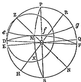
以某適宜大之弦尺爲半徑。畫本初圓  $PESQ$ 。表通過該地方之子午圈。引直徑  $ECQ$ 。表赤道。又引直徑  $POS$ 。令與赤道直交。表地球之軸。或第六時之時圈。又從極至太陽赤緯度之餘角  $67^{\circ} 30'$  之距離。作小圓  $efg$ 。表就太陽的觀測時所定之平行圈。通過赤道之兩極  $P, S$ 。引大圓  $PMS$ 。與最初圓。於觀測時太陽之角距。爲  $51^{\circ} 55'$  之傾斜。此圓與太陽赤緯度之平行圈相交於  $M$ 。則  $M$  表太陽的觀察確定之點。以  $M$  爲極。於太陽之天頂  $40' 8''$  之距離。畫小圓  $ZDX$ 。交子午圈於  $Z$ 。則  $Z$  爲所求緯度之天頂。而引直徑  $ZON$ 。表最初直立圈。與此成直角。引直徑  $HOR$ 。表所求緯度之地平線。故  $PZ$  爲極與天頂之距離。即所求緯度之餘角。
