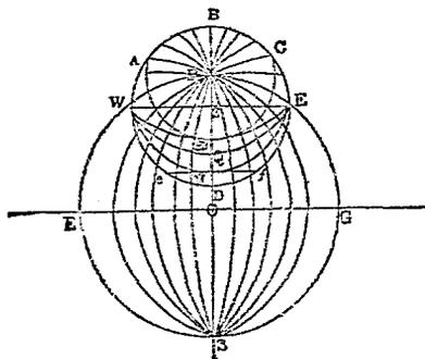
通過 E, P, W 之子午圈。即時圈。引 EPW 最初直立圓。與地平線東西 E, W 點直交。則通過第六時之時圈  $\odot$ 。與子午圈 EWD 直交。引直徑 F $\odot$ G。從其半徑 G $\odot$ 。 $\odot$ F 上。取  $15^\circ, 30^\circ, 45^\circ, 60^\circ, 75^\circ$  之正切尺。從此與中心  $\odot$  重合。而截取各點爲子午圈之中心。即時圈之中心。而表子午圈。則以此點爲中心。向兩方如圖以作。即得。
