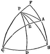
有  $\triangle ABC$ . 從  $B$  及  $C$  之兩端. 作  $\angle PBC = \angle PCB = \frac{1}{2}(B+C)$ . 引  $\widehat{PB}$ .  $\widehat{PC}$  會於  $P$  點. 而連結  $PA$ . 又從  $P$  向  $BC$ ,  $CA$ ,  $BA$  各作垂線  $PD$ ,  $PE$ ,  $PF$ . 則
