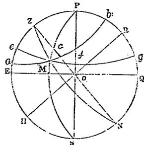
今此圓與  $efg$  圓相交於  $M$  點。則  $M$  爲太陽之地位。通過  $P, M, S$  三點。引子午圈  $PMS$ 。又通過  $Z, M, N$  三點。作直立圈。則球面三角形  $PZM$ 。均爲既知之量。因  $PZ$  爲緯度之餘角。 $ZM$  爲實高度之餘角。 $PM$  爲赤緯度之餘角。
