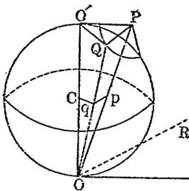
有圓之某點Q，於P之周圍，作切於球之圓錐體，則O為射影之中心，p, q為P, Q之射影。平面OPQ為射影平面。於pq線相會。又於O點引pq之平行線OR，作含OR之切平面，則OR, PQ為球之切線，而OQ為連結切點之弧之弦。
