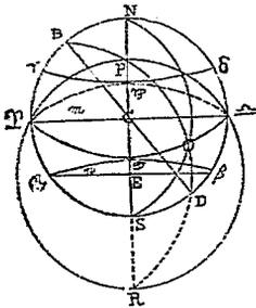
又由本初圓之中心  $C$ . 以太陽最大緯之餘角  $66^{\circ} 32'$  半正切尺. 在二至徑圈上. 取  $CP$  之距離. 則  $P$  表距赤道之極至  $23^{\circ} 28'$  之黃道極. 確定其面在通過夏至冬至二點之子午圈或時圈上.
