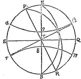
次通過夏至冬至二點. 且與赤道平行. 作小圓  $\alpha\beta\gamma\delta$ . 表示太陽最大赤緯度之界限.  $\odot$  爲所設定時間太陽之位置. 而通過 N,  $\odot$ , S 三點. 作 N $\odot$ S 圓. 通過 P,  $\odot$ , R 三點. 作 R $\odot$ P 圓. 一表子午圈或時圈. 其他表黃經度. 而此二者同過二點. 一個中心在 E P Q 上. 其他中心在  $\odot\alpha\beta\gamma\delta$  上.
