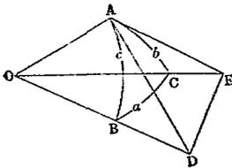
ABC 爲球面三角形. O 爲球之中心. 就弧 AB 之 A 點. 作切線 AD. 交 OB 之延長於 D. 又自弧 AC 之 A 點. 作切線 AE. 交 OC 之延長於 E. 連結 DE. 則由  $\triangle ADE$  及  $\triangle ODE$ . 可得次式.
