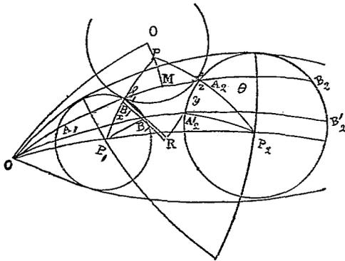
$T_1, T_2$  為與二小圓切於  $T_1, T_2$  之大圓.  $P_1, P_2$  為小圓之中心. 則  $P_1 T_1, P_2 T_2$  在  $T_1 T_2$  之極  $P$  點相會. 今三角形  $PP_1 P_2$  之二邊  $PP_1$  及  $PP_2$  為  $90^\circ - r_1, 90^\circ - r_2$ . 但  $r_1, r_2$  為兩小圓之半徑. 故依決定  $PP_1, PP_2$  之理. 得以決定  $P$  點之位置. 故引長  $PP_1, PP_2$  交小圓周於  $T_1, T_2$ . 通過  $T_1, T_2$  畫大圓. 是即所求之圓.
