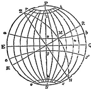
最初作圓 EPQS，通過赤道左右各  $15^{\circ}$ ，作他之子午圈或時圈，依前之方法，作回歸線，及極圈，赤道圈與軸互為直交。從 E 至北緯  $51^{\circ} 28' 39''$  之弧，截取最初子午圈，是為 EZ，從 Z 引直徑  $Z \odot N$  作直立圓，則表最初直立圓，或東西之地平經度，其 Z 為天頂，N 為其對點。
