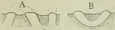
Fig. 1. — Conditions tectoniques favorables au régime de circulation torrentielle souterraine (A) et au régime de nappe aquifère (B).
