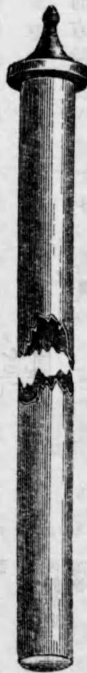
シヤムベラン氏濾過器 (全形及内部ノ空洞ヲ示ス)
