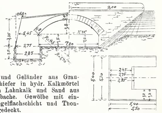
Gewölbe und Geländer aus Grauwacken-Schiefer in hydr. Kalkmörtel (1 : 3) von Lahnkalk und Sand aus dem Dörsbache. Gewölbe mit einfacher Ziegelfläch-schicht und Thouschlag abgedeckt.
