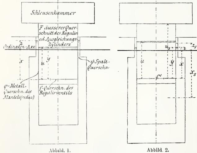
Die Bedeutung der sonstigen Bezeichnungen ergibt sich aus den Figuren oder ist besonders angegeben. Die Größen  $F$ ,  $f$ ,  $q$ ,  $\psi$  bedeuten, wenn mehrere Schwimmer vorhanden sind, die bezgl. Gesamt-Querschnitte.
