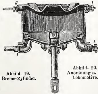
Abbildung 19. Brems-Zylinder.
