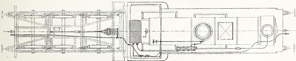
Abbild. 29. Luftdruck-Bremse. System Westinghouse.
