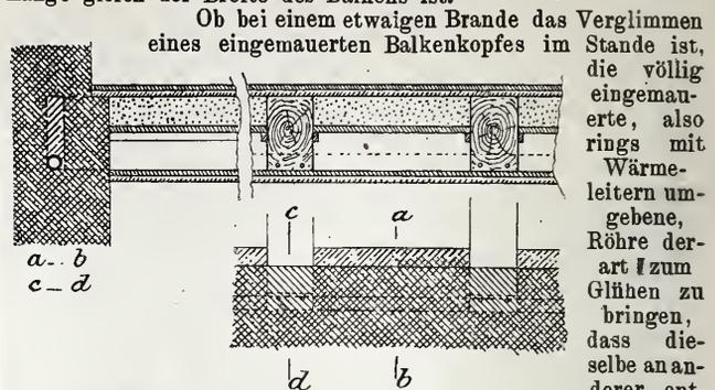
Ob bei einem etwaigen Brande das Verglimmen eines eingemauerten Balkenkopfes im Stande ist, die völlig eingemauerte, also rings mit Wärmeleitern umgebene, Röhre derart zum Glühen zu bringen, dass dieselbe an anderer entfernter Stelle einen mit der Stirne nahe liegenden Balken entzünden kann, muss mindestens bezweifelt werden; der Brand müsste jedenfalls schon grosse Ausdehnung angenommen haben, bevor die Röhre ihre Thätigkeit in zerstörender Weise nur beginnen könnte.
