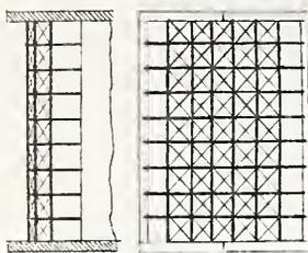
Im übrigen ist die ganze Konstruktion so ungemein einfacher Art, dass kaum noch eine weitere Erläuterung erforderlich ist. Dass das ganze System stabil ist, erkennt man leicht aus der Betrachtung der Kräfte, welche bei einer beliebigen Belastung auftreten. Gestaltet man das Sparrenpolygon (also die Leitlinie der Tonne), so, dass es mit einem Seilpolygone für die bleibende Dachlast zusammen fällt, so erfahren durch diese
