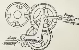
Abbild. 4 u. 5. Reibungs-Bremse von Heberlein.
