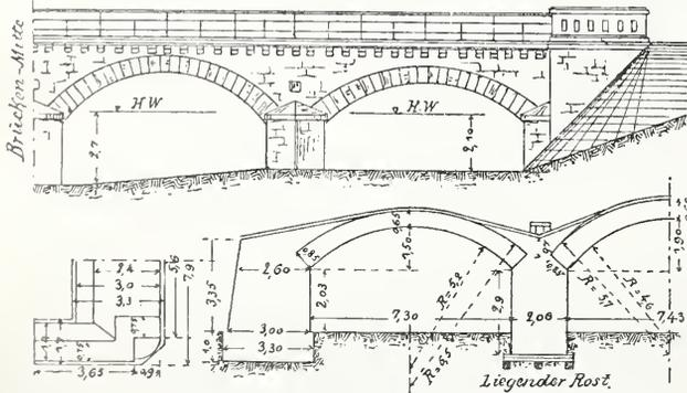
18. Elbbach-Brücke. (Hadamar-Niederzeuzheim b. Niederzeuzheim.) Auf alte Fundamente gebaut. Mauerwerk aus Grauwacke und Plattenbasalt in hydraulischem Kalkmörtel (1:3) von Lahnkalk u. Bimssand von Sulz. Gewölbe aus Bruchstein mit dopp. Ziegelflachschiicht u. einer wasserdichten Zementmörtelschicht abgedeckt. Gesims, Abdeckung, Geländerpfeiler theils aus Sandstein, theils aus Basaltlava.
