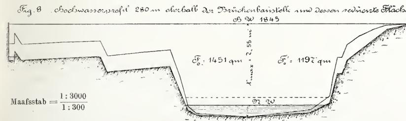
Für ein weiteres Hochwasser-Profil, 280 m oberhalb der Brückenstelle, woselbst die Wasserbewegung eine freiere ist, so dass ein besserer Anhaltspunkt vorhanden ist, wurde  $F_0 = 1451$  qm;  $b_0 = 330$  m;  $F_1 = 1197$  qm;  $b_1 = 159$  m;  $n = 0,0244$  m.
