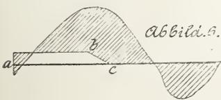
In wie einfacher Weise sich Abweichungen der Ausführung berücksichtigen lassen, ist durch Abbildung 6 angedeutet. Es ist hier angenommen, es seien in die Ablagerung  $a$  mehr Massen gebracht worden, weil bei  $b c$
