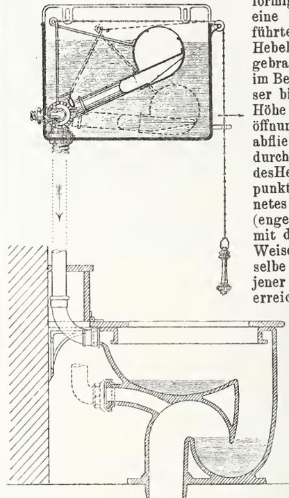
und das Abflussventil öffnet und so dem Wasser den Weg durch das Kloset frei macht; dadurch kommt auch das sonst erforderliche Ueberlaufrohr in Wegfall. Ein kleiner Vorzug der Einrichtung besteht darin, dass der Gefahr der Entleerung des Wasserschlusses durch die Heftigkeit der Spülung dadurch abgeholfen wird, dass das bei tiefstem Stande des Schwimmers in demselben stehende Wasser während der nachfolgenden Hebung langsam abflieset und den etwa aufgehobenen Wasserschluss wieder herstellt.
