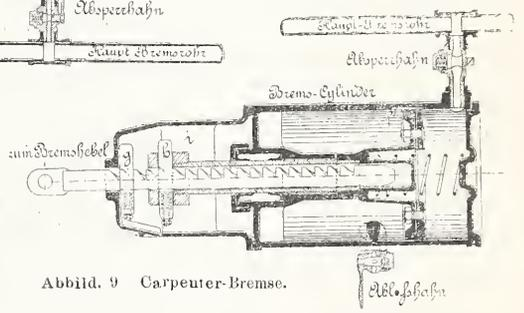
Abbild. 9. Carpenter-Bremse.
