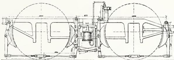
Abbild. 30. Treibrad-Bremse von Westinghouse.
