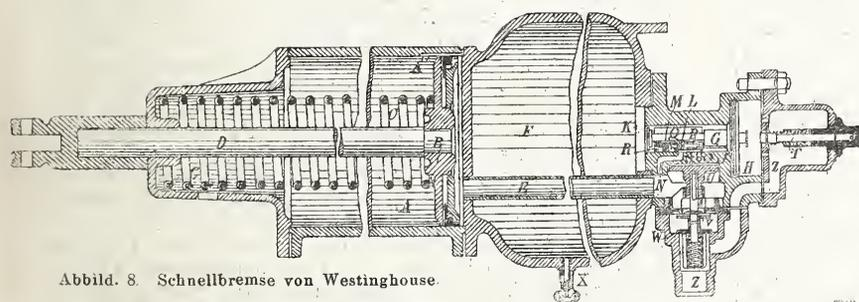
Abbild. 8. Schnellbremse von Westinghouse.
