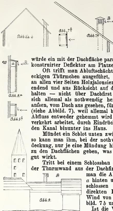
ist eine Schutzplatte parallel mit der Dachfläche zu empfehlen Abbild. 6.
