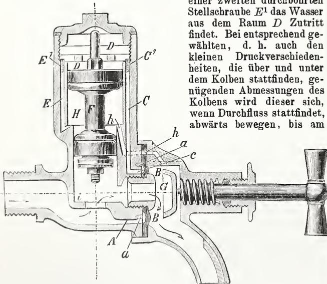
Ende einer gewissen Dauer, d. h. wenn eine gewisse Wassermenge durchgeflossen ist, der Schluss der Oeffnung i erfolgt und damit der weitere Durchfluss aufhört; während der Laufdauer wird das zwischen den beiden Kolben in dem Raume II befindliche Wasser durch den engen Kanal h den Austritt gewinnen.
