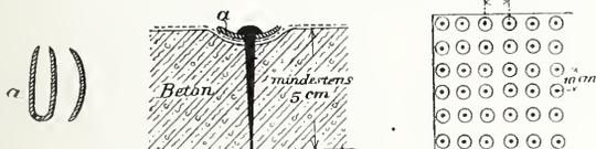
Die Ansichten über die Zweckmäßigkeit dieser Zwischennägel stimmen nicht überein. Das Einsetzen der Nägel in die Holzklötze erfolgt durch Knaben, welche häufig nicht genügende Sorgfalt auf das gleichmäßige Eintreiben der Nägel verwenden, so dass eine gleich starke Fuge der Reihen nicht erzielt wird. Die Fugen werden meistens mit Zement ausgegossen.
