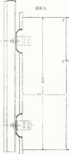
wohl in senkrechter als wagrechter Richtung voll zur Geltung kommt. Dabei wird derselbe nicht mit den senkrechten Wänden verbunden, sondern lose auf an denselben befestigte hochkantig gestellte Flacheisen f gelegt und mit einigen kleinen Löchern versehen zum Zwecke der Entwässerung u. Verhütung
