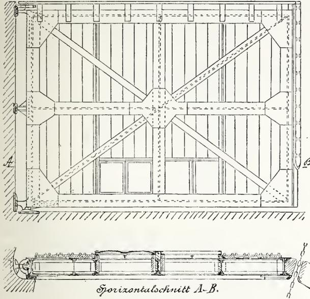
Abb. 1. Thorflügel der Schleuse zu Ablon.
