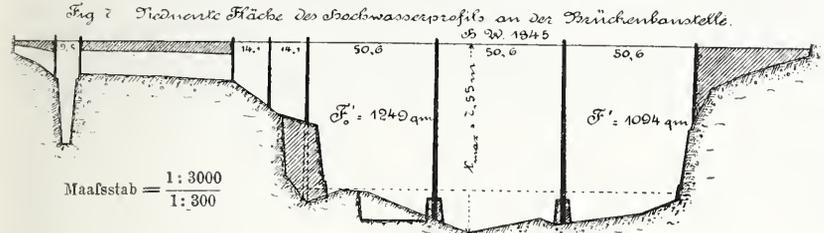
Flussgefälles  $J = 0,00047$  und eines Rauheitsgrades  $n = 0,025$  (vorläufige Annahme), wurde die reduzierte Fläche  $F_0' = 1249$  qm, die reduzierte Wasserspiegelbreite  $b_0' = 166$  m.
