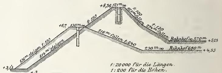
Ober- und Unterwasser — das ist 1,8 m — weniger anzusteigen braucht. Die beigedruckte Abbildung zeigt in verzerrtem Massstabe das alte und das in Vorschlag gebrachte Längenprofil des Bahngleises mit den alten und den von mir geplanten neuen Steigungen.
