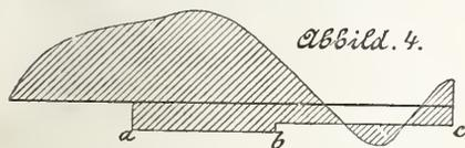
In Abbildung 4 ist angenommen, dass bei  $a$  mehr Massen, bei  $b$  weniger zu verziehen gewesen sind und der Unterschied bei  $c$  in die Ablagerung mehr verbracht werden müsse.
