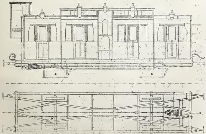
Abbild. 11 u. 12. Anbringung der Carpenter-Bremse an Personenwagen.
