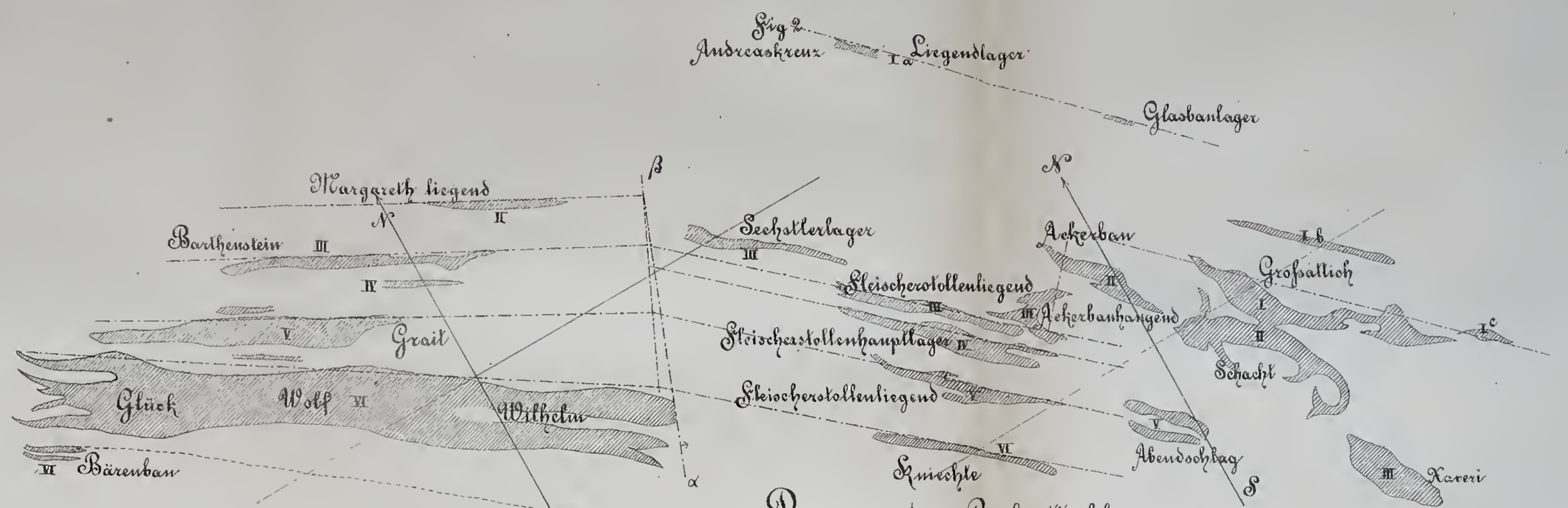
Das Erzlagersystem des Sülzenberger Erzberges auf das Niveau des Löllinger-Erbstollens reducirt. Maßstab 1:5760
