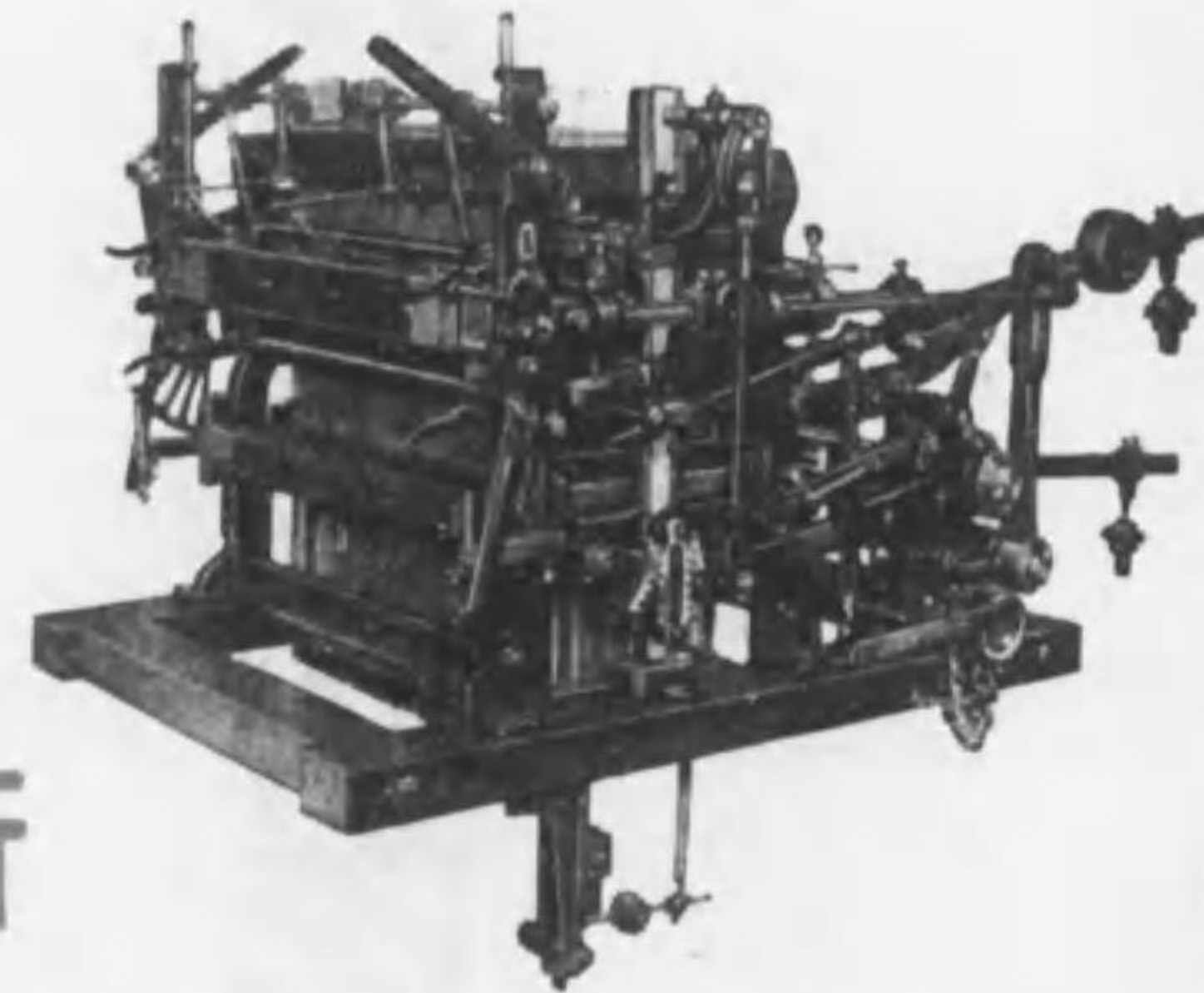
特許 シングル・シリンダー クロス・ボーダー ジャカード機
