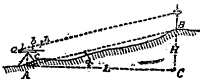
圖六十第 定測桿斜傾 時之等相高視覘與高板覘 一 其 (測登)
