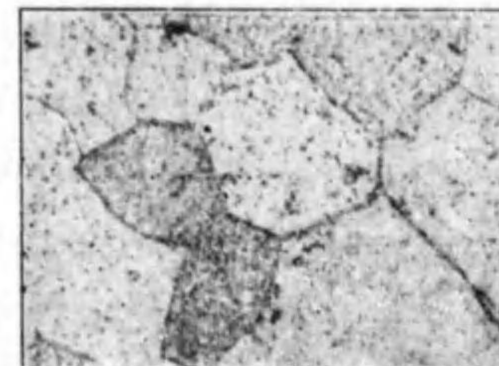
第7圖 鑄造の儘の \alpha 組織 \times 100
