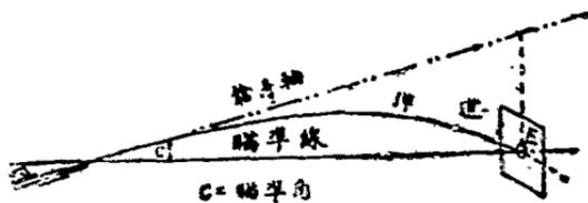
高角(第五圖)者。發射前取發射位置之槍身軸與水平面所成之角也。發射角。(第五圖)者。子彈離槍口時槍身軸與水平面所成之角也。第十。高角與發射角。常有微小之發射差角。以起因於發射時槍身之動搖爲主。因火器及彈藥之種類。而有差異。固勿待言。卽在同一火器。亦不能相同。
