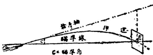
高角（第五圖）者。發射前取發射位置之槍身軸與水平面所成之角也。
