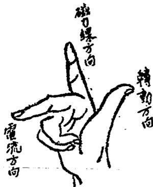
之。旋轉的時候，因割過磁力線，線圈中發生電流，由銅環接出外電路。電流方向，視線圈旋轉方向和磁力線方向而定。三者的關係，可用佛來銘右手定則決定之。以右手伸出大指，食指和中指互成直角，大指指線圈轉動方向，食指指磁力線方向，中指所指，即為電流方向，如同圖 B 所示。今假定 A 圖的線圈旋轉方向，如弧形箭頭所指，磁力線方向為自上而下；依照佛來銘右手定則，線圈中的電流方向，當如直箭頭之所指。
