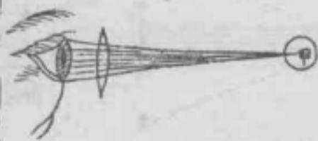
世有目少好遠游喜遠望者年老目衰則不苦視遠物而苦視近物不耐三角形射線而耐平行射線習性使然耳若用遠鏡之中高鏡則物象一點之小散射鏡面從鏡平行入目巧合其習性視近不勞而自明也然又有未嘗好遠遊遠望而平日專務平直是視者亦必老至力衰
