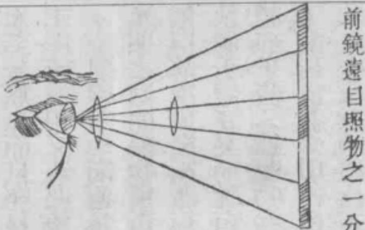
二鏡之性乃相反以相制者也。獨用則偏並用則得中而成器焉。夫遠物發象從平行線入目，則目視遠物亦必須從平行線視象。假若二鏡獨用其一，則前鏡中高而聚象，聚象之至則偏偏，則不能平行。後鏡中窪而散象，散象之至則亦偏偏，亦不能平行。故二鏡合用，則前鏡賴有後鏡，自能分而散之，得乎平行。
