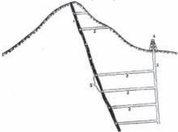
ಚಿತ್ರ 2. ಖನಿಜ ಸಿರದಿಂದ ಅದಿರನ್ನು ಪಡೆಯುವ ಬಗೆ. 1. ಲೋಹ ಅಡಗಿರುವ ಸಿರ, 2. ಅಡ್ಡ ಸುರಂಗಗಳು, 3. ಮುಖ್ಯ ಕೂಪ, 4. ಮುಖ್ಯ ಕೂಪದ ಮೇಲಿನ ಗೋಪುರ, 5. ನೂರು ಅಡಿ ಅಂತರವಿಟ್ಟು ತೋಡಿರುವ ಮಟ್ಟಗಳು
