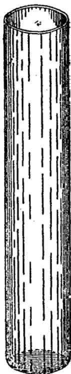
將鋅片圓筒置於廿五或卅公厘口徑玻璃圓筒內，普通化學試驗管，亦可應用，惟玻璃太薄易碎，最好用較厚平底玻璃管，儀器店有售。或玻璃瓶截去上口，再將正電極插入鋅筒內面，玻璃管上口用有孔軟木塞(參閱第廿八圖)塞緊，炭條上端由軟木孔穿出外端，隨用銅帽緊套於炭條之頂端。軟木塞上鑽孔，可用軟木鑽孔器，或用相當粗細之薄銅管，將一端銼成銳口，置軟木上，用力壓
