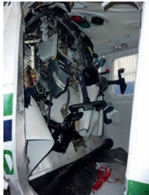
Figuur 5 en 6: zijaanzichten deformatie van de vliegtuigneus en de cockpit (stoelen verwijderd) Links: beschadiging vliegtuigneus, cockpitvloer omhoog geknikt Rechts: instrumentenpaneel tegen het dak
