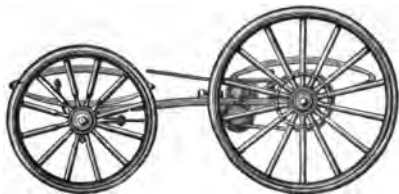
7. Повозочный станъ и 8. расположение движущаго механизма коляски фирмы „American Vehicle Co.“
