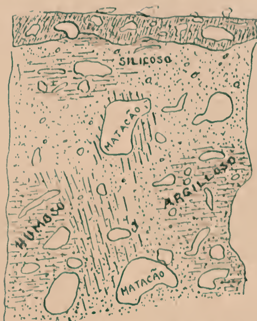
Diagramma representando uma secção caracteristica de solo lavrado de locação glacial onde ha falta de escolha e estratificação. Material fino e grosso em mistura desordenada.
