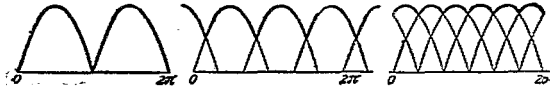
圖567. 關於單相交流，三相交流及六相交流之電壓曲線及電流曲線
