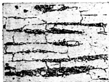
图5 \phi 152 \times 8 毫米管材热后750°C \times 3 小时空冷， \times 500
