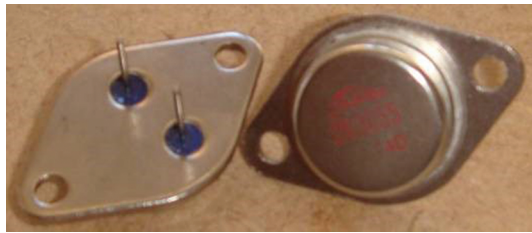
Figura 1: Transistor 2N3055 em encapsulamento metálico (TO-3). Fonte: foto dos autores.
