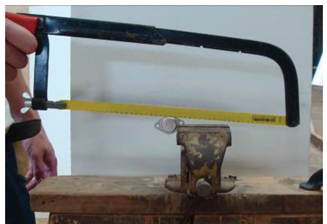
Figura 4: Retirando a tampa do 2N3055. Fonte: foto dos autores.
