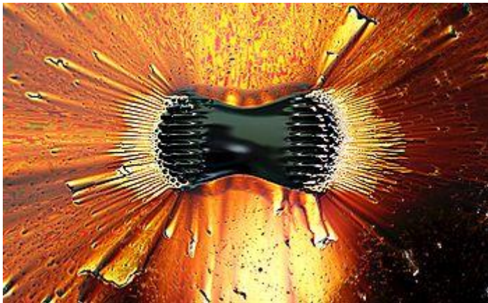
Figura 35. Ferrofluido que se agrupa cerca de los polos de un magneto poderoso. http://commons.wikimedia.org/wiki/File:Ferrofluid_poles.jpg
