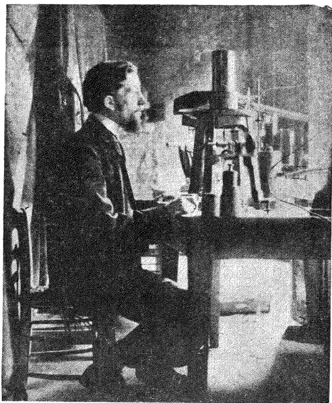
居禮 及其發明之石英壓力電靜電計
