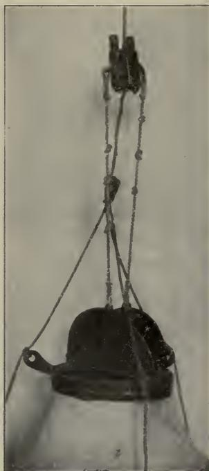
Fig. 61. Apsteins Klappenschließnetz (oberer Teil).
