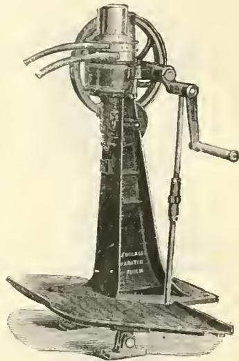
Fig. 79. — Ecrémeuse centrifuge à manivelle et à pédale.
