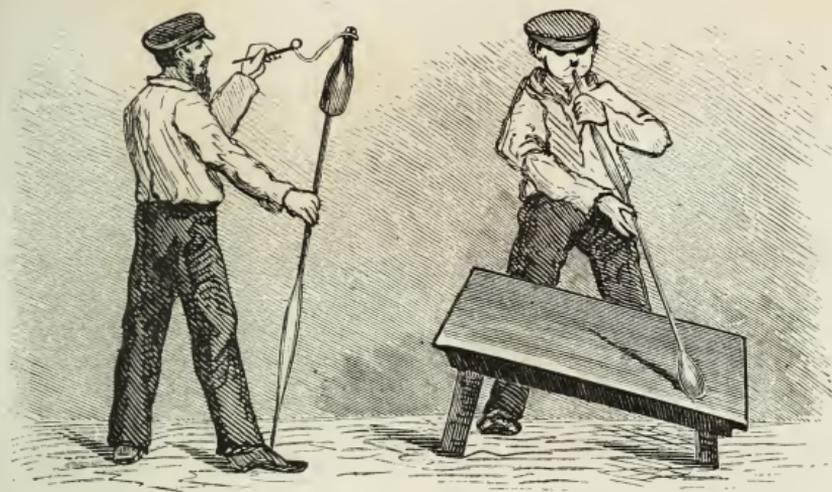
Fig. 20. — Fabrication des bouteilles. — Paraison du verre.
