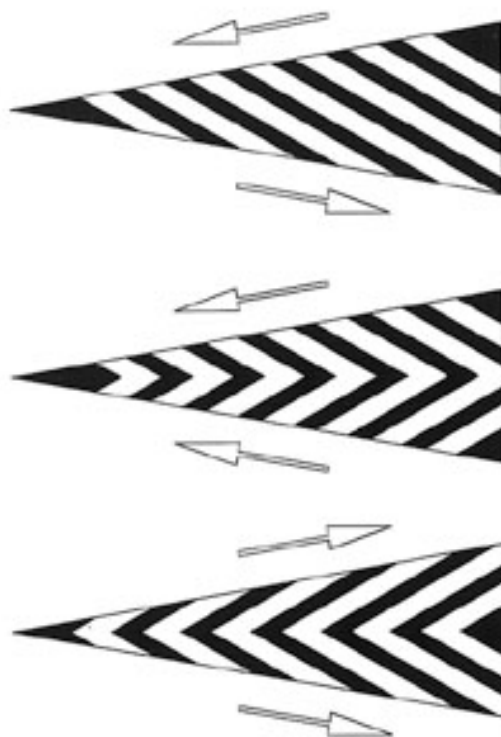
Spații interzise circulației
