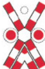
Trecere la nivel cu o cale ferată dublă, fără bariere, prevăzută cu semnale luminoase de avertizare a apropiării trenului
