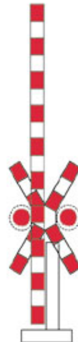
Trecere la nivel cu o cale ferată simplă cu semibarieră, prevăzută cu semnale luminoase de avertizare a apropiării trenului
