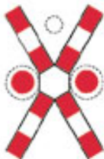
Trecere la nivel cu o cale ferată simplă, fără bariere, prevăzută cu semnale luminoase de avertizare a apropiării trenului
