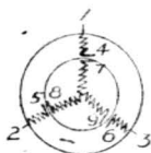
電機殼之線路圖解
