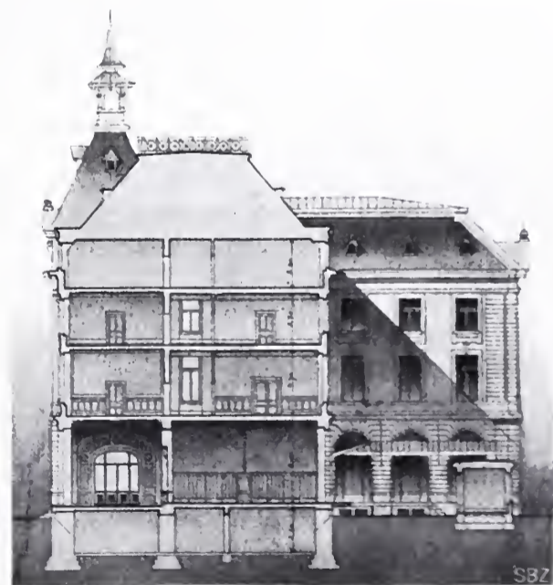
Querschnitt durch den Mittelbau. — 1 : 600.
