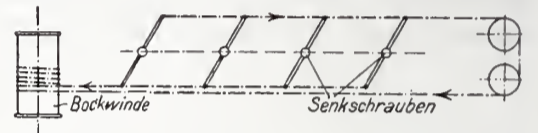
Abb. 8. Schematische Darstellung des Anziehens der Senkschrauben.
