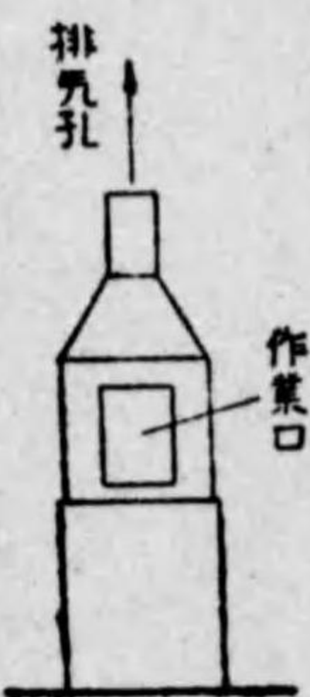
加熱槽有毒「ガス」排氣裝置
