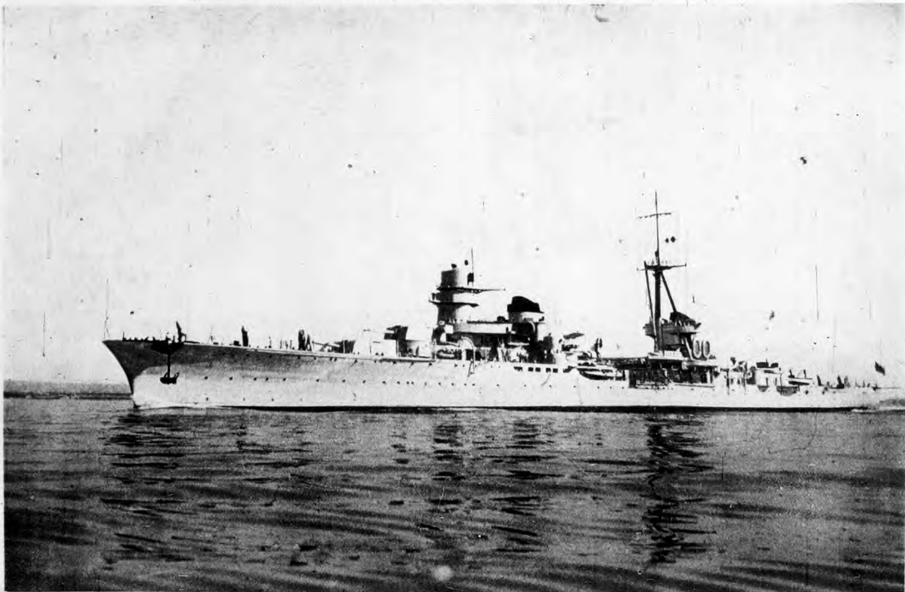
六量水排者見未所艦軍此前亦壘堡如狀甲護有均部全台駛駕其湮九十三達湮二出超竟時試公湮七十三定原高特率速故穎新樣式艦該 架二機察偵上水排兩管射發雷魚管三尊六砲射高的生十座四塔砲聯雙的生二·五十裝突米五·七一寬突米五九·六八一長噸百九千
