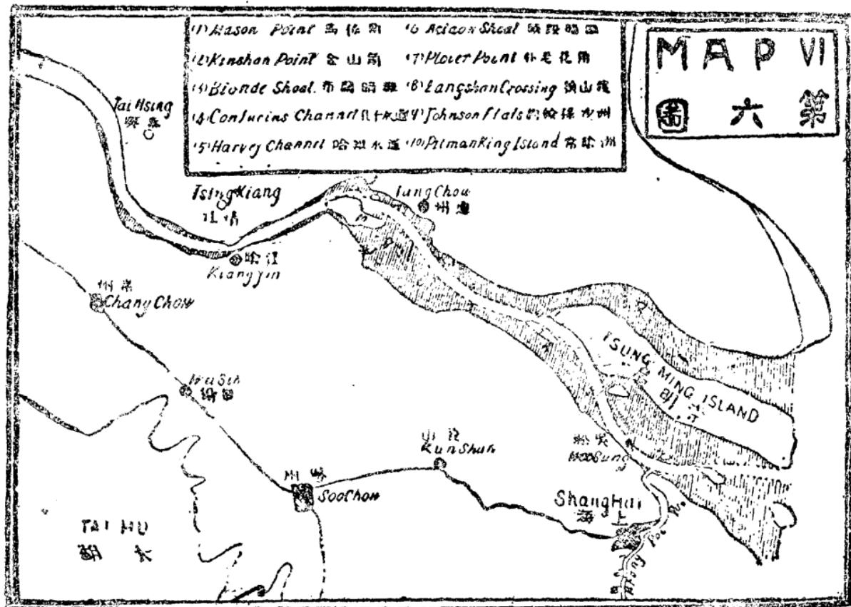
西北約六英里處。接於灘邊。然後沿崇明灘邊。直至馬孫角。（譯音）然後轉而橫過北水道。離北岸約三四英里。作一平行線。直抵金山角。（譯音）在此處截斷近年新成之深水道向西南。以與靖江縣城東北河岸相接。沿此岸再築七八英里。又挖開陸地。以增河身之闊。令其自江陰礮臺脚下起。算至對岸。常有一英里半之距離。此自崇寶沙至江陰對面之靖江。河堤共長約一百英里。
